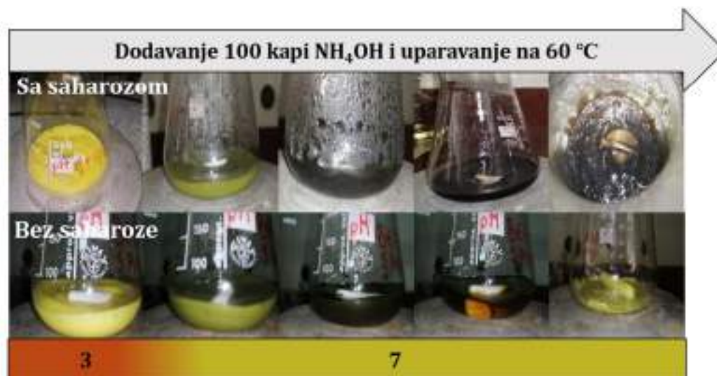
Slika 4.3. Promjene boje usled dodavanja 100 kapi \text{NH}_4\text{OH} tokom sinteze NFPP_L0015SC_7 i NFPP_L0015C_7 materijala, kao i gelovi nakon uparavanja na 60\text{ }^\circ\text{C} .
