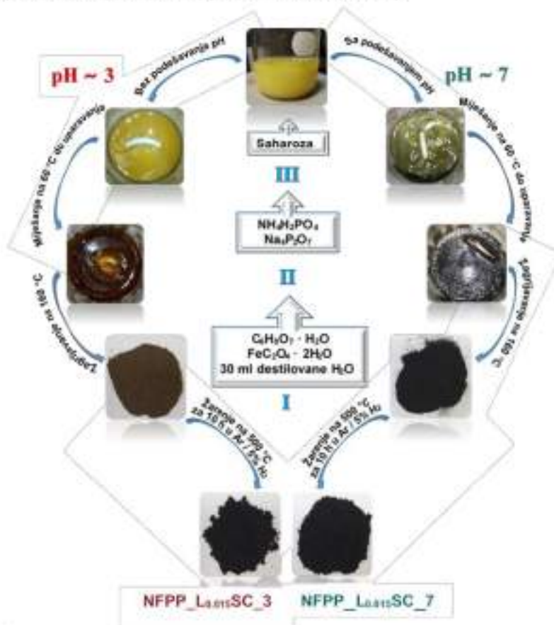
Slika 3.1. Šema postupka sinteze NFPP_L0.015SC_3 i NFPP_L0.015SC_7 materijala.
